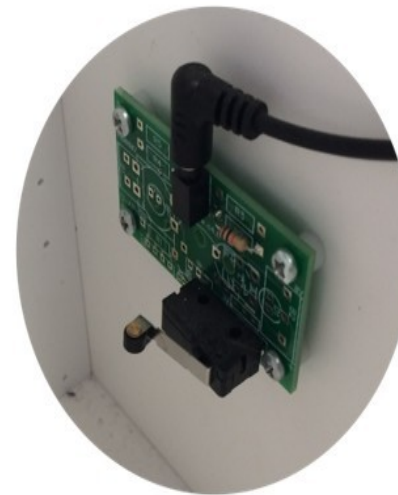
Le micro-rupteur à galet est contacté quand la porte s'ouvre et « appuie sur le galet »
