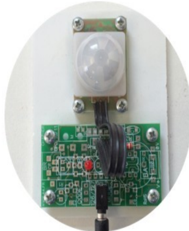
Capteur infrarouge : détection des personnes
